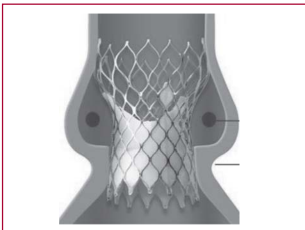
Fig. 6. Esquema de la válvula CoreValve posicionada a nivel del anillo valvular y respetando los orígenes de las arterias coronarias.
